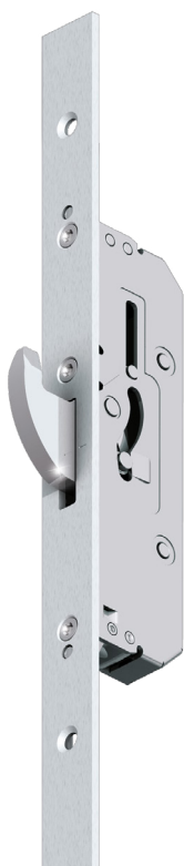
Serrature di Tipo 3: serratura a 3 punti azionata da chiave o maniglia, con catenaccio centrale e catenaccio superiore e inferiore per una sicurezza elevata.
